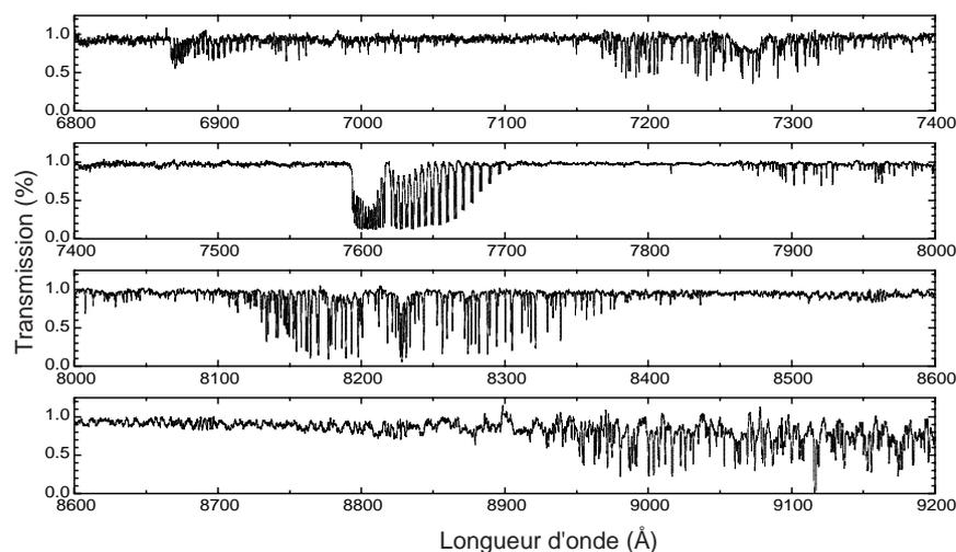
Figure 5. Analyse à haute résolution du continuum de lumière blanche rétroémis d'une altitude de 4 km. On observe très clairement toutes les bandes de H<sub>2</sub>O et O<sub>2</sub> entre 680 nm et 920 nm
