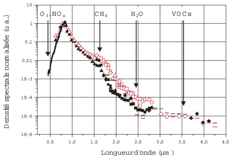
Figure 4. Spectre du continuum de lumière blanche généré par un laser ultrabref (100 fs) et de forte puissance (2 TW)
