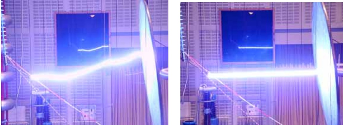
Figure 7. Décharge non guidée sans laser (à gauche); décharge guidée par les filaments (à droite)
