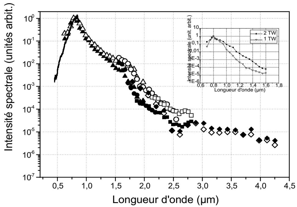
Fig. 1 L'intensité spectrale du continuum émis par un filament.
