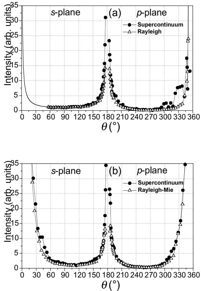
Fig. 2. Distributions angulaires du continuum émis par un filament comparées aux diffusions linéaires de Rayleigh et de Mie : (a) mesurées dans un air propre, donc la diffusion de Rayleigh uniquement dans le régime linéaire [fit Rayleigh  $1/\sin(\theta)$  pour le s-plan ] et (b) mesurées dans un air contenant des poussières, donc les diffusions de Rayleigh et de Mie dans le régime linéaire.
