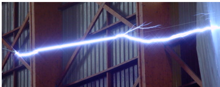
Fig. 1 Décharge déclenchée et partiellement guidée par des filaments pour une distance entre les électrodes de 4,5 m.
