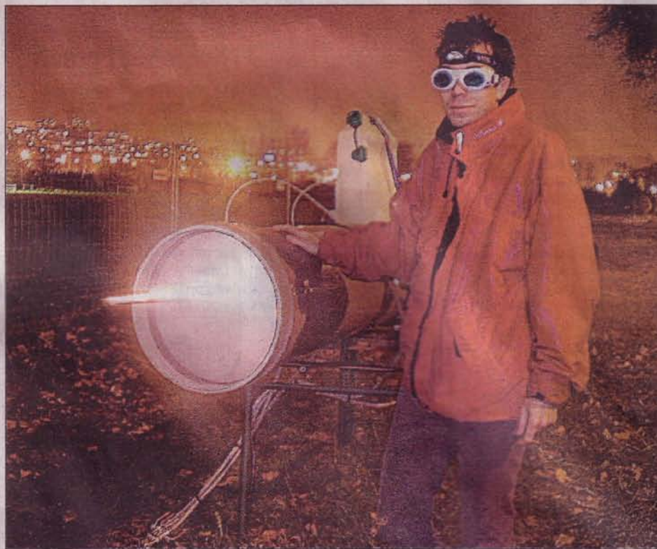
Démonstration de la télé-détection de simulants d'aérosols biologiques avec le laser Téra-mobile. Le "tube" est une chambre à nuages où un brouillard est produit. Le faisceau laser Téra-mobile arrive de la gauche, illumine ce brouillard (la ligne blanche lumineuse à l'entrée de la chambre à nuages), et permet de l'analyser. On peut ainsi détecter, localiser et identifier un aérosol biologique à distance. DAVM/Université Lyon 3/Alexis Gratié
