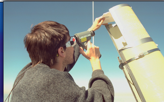
Jérôme Kasparian, chercheur CNRS au Lasim, règle le chemin du faisceau laser TéraMobile
