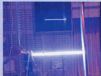
Grâce à ses propriétés conductrices, le laser Téramobile permet de déclencher et de guider des décharges de haute tension (1 million de volts) : à gauche, la décharge "naturelle"; à droite, la même décharge guidée par le laser.
