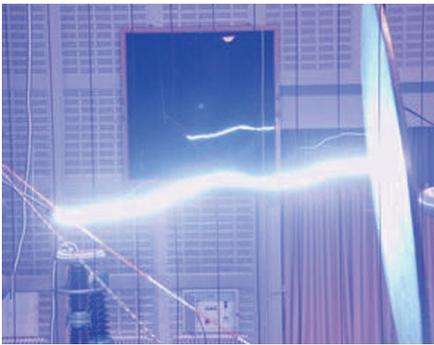
**Bild 3.** Stoßspannungsdurchschlag [6–7]
